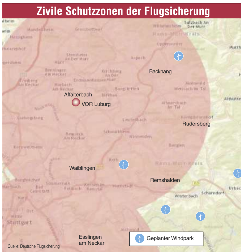
Die geplanten Windkraftanlagen auf der Buocher Höhe und bei Backnang befinden sich innerhalb des 15-Kilometer-Schutzgebietes um das Funkfeuer VOR Luburg bei Affalterbach.
